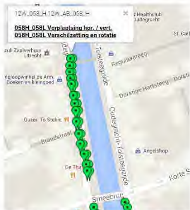
Figuur 2: locaties prisma's op de werfmuur [Bron: WePGIS]
